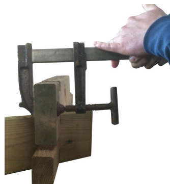
Redirected board • Tabla redirigida • Madrier redressé • neu ausgerichtetes Brett • Tavola riposizionata • Rechtgebogen plank • Tábu redirigida
